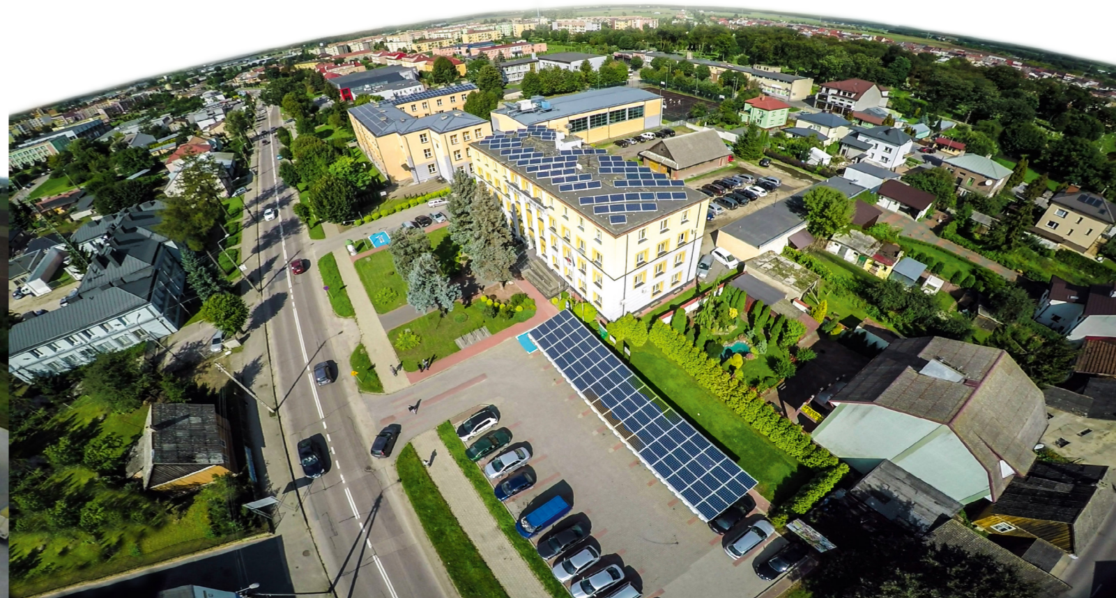
Urząd Miasta Kolno. Na najważniejszych budynkach użyteczności publicznej w Kolnie posadowione zostały panele fotowoltaiczne.
